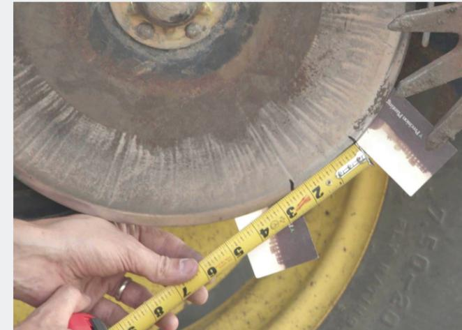
disque, puis de même par le haut du disque. Ensuite mesurez l'espacement entre les deux cartes, si besoin réajustez le point de contact par le biais des rondelles à l'intérieur des disques.
