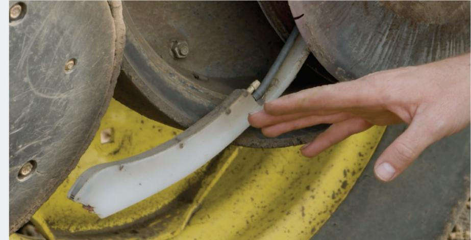
Lorsqu'une graine tombe du tube de descente dans le sillon, vous voulez que celle-ci se loge au fond du sillon, sans poche d'air en dessous. Une languette de rappui sur chaque rang vous permettra de rappuyer la graine au fond du sillon et donc maintenir un bon contact terre-graine et assurer la germination.
