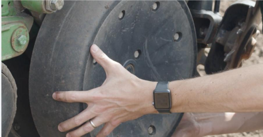
Une émergence uniforme signifie que chaque graine est dans un environnement humide, favorable à la germination. Une partie sensible sur le semoir pour conserver l'humidité est : le réglage des roues de jauge.
