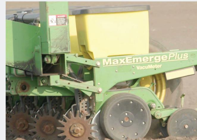
soient de même longueur et que le semoir soit de niveau sur la largeur, réglez aussi le 3ème pont afin que le semoir soit de niveau sur la longueur. N'oubliez pas de désactiver les automatismes de votre tracteur tels que : Le contrôle d'effort et de position.
