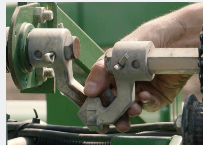
Les vibrations causées par les composants mécaniques tels que, les chaînes, les arbres d'entraînement et les roulements peuvent affecter les performances de votre distribution. Assurez vous du bon état des composants suivants :
