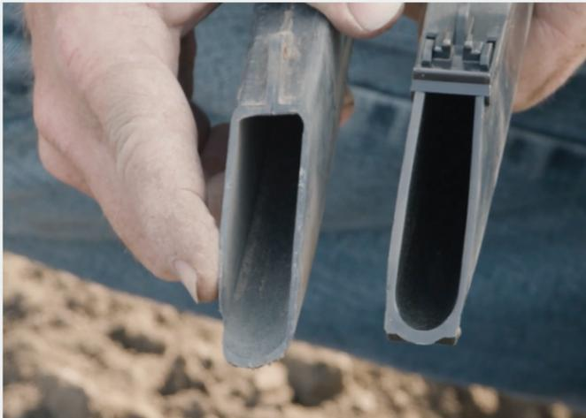
Afin de contrôler l'usure de vos socs comparez avec des pièces neuves est un gage de réussite, si vous n'avez pas de pièces neuves, contactez votre revendeur Precision Planting afin d'être conseillé. Vous devez aussi, toujours remplacer les protections de tube de descente dès lors que vous changez vos disques ouvreurs sur le semoir.
