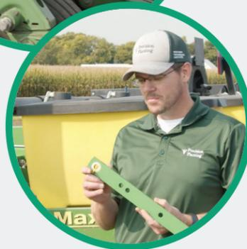
Les bras de parallélogramme assurent un suivi du sol en douceur au fil du travail. Si il y a de l'usure à ce niveau, vous constaterez certainement une profondeur incohérente qui mènera elle à une émergence décalée. Cela affectera aussi l'espacement entre graines en raison des vibrations que cela entraîne.
